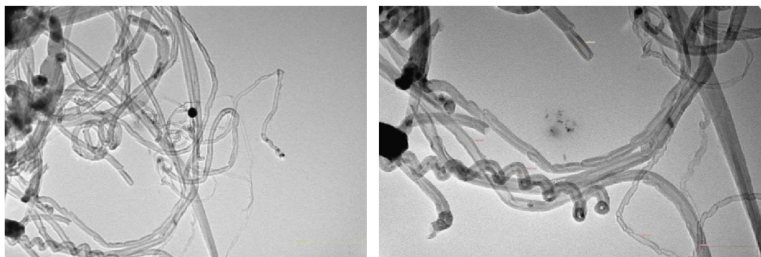
Рисунок 3 – ПЭМ изображения углеродных нанотрубок и нановолокон, выращенных на стеклоткани с \text{Fe}_2\text{O}_3 (2 % масс.)
