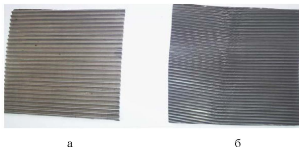
1-сурет – Гофрленген фольга үлгілері: а – қарапайым типті каналды фольга; б – «шеврон типті» каналды фольга
