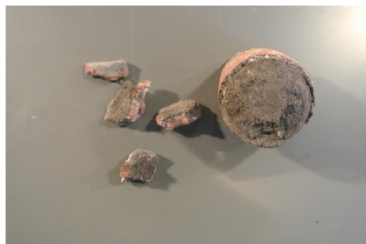
Рисунок 3 – Полученный образец после СВС в высокотемпературной центрифуге
