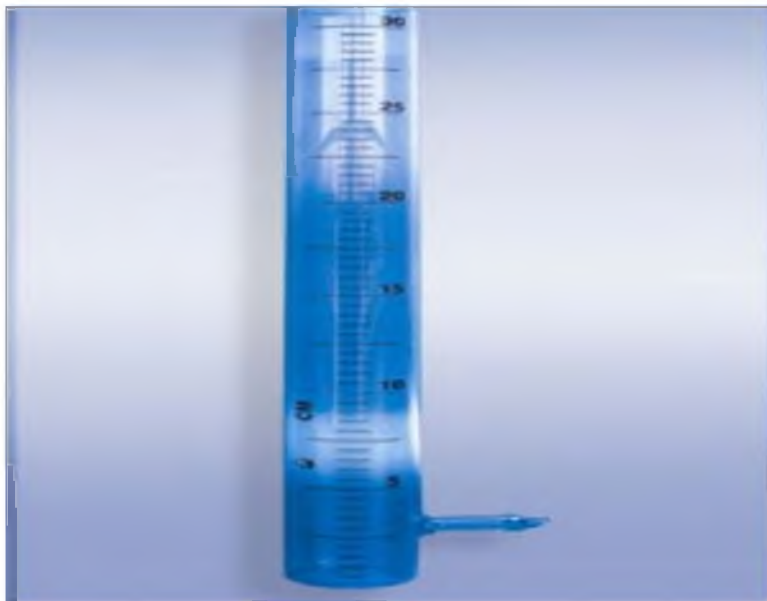
1-сурет-Судың мөлдірлігін анықтауға арналған Снеллен цилиндрі.
