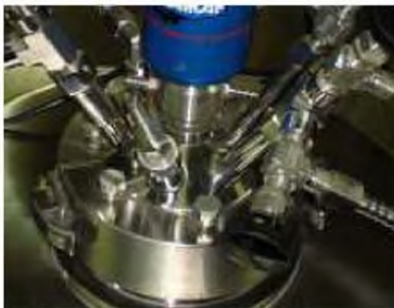
Рисунок 2 – Крышка безопасности и Разрывной диск автоклава Amar Equipments Pvt. Ltd
