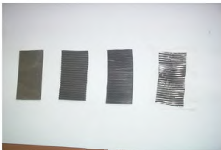
Рисунок 1 – Гладкая (крайняя слева) и гофрированная фольга
