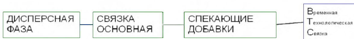
Рисунок 6 – Типичный состав шликера для получения ВПЯМ
