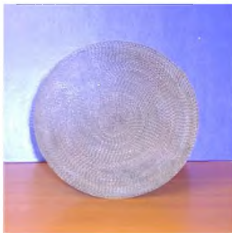
Рисунок 3 – Каталитический нейтрализатор на блочном металлическом носителе
