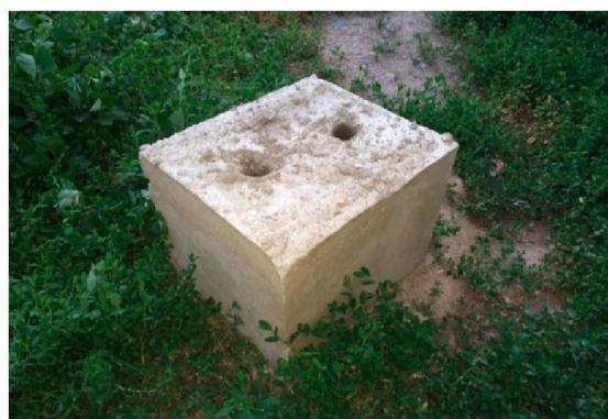
Рисунок 3 – Железобетонная колона с 2-мя патрубками для ввода газогенератора работающего в режиме дефлаграционного горения
