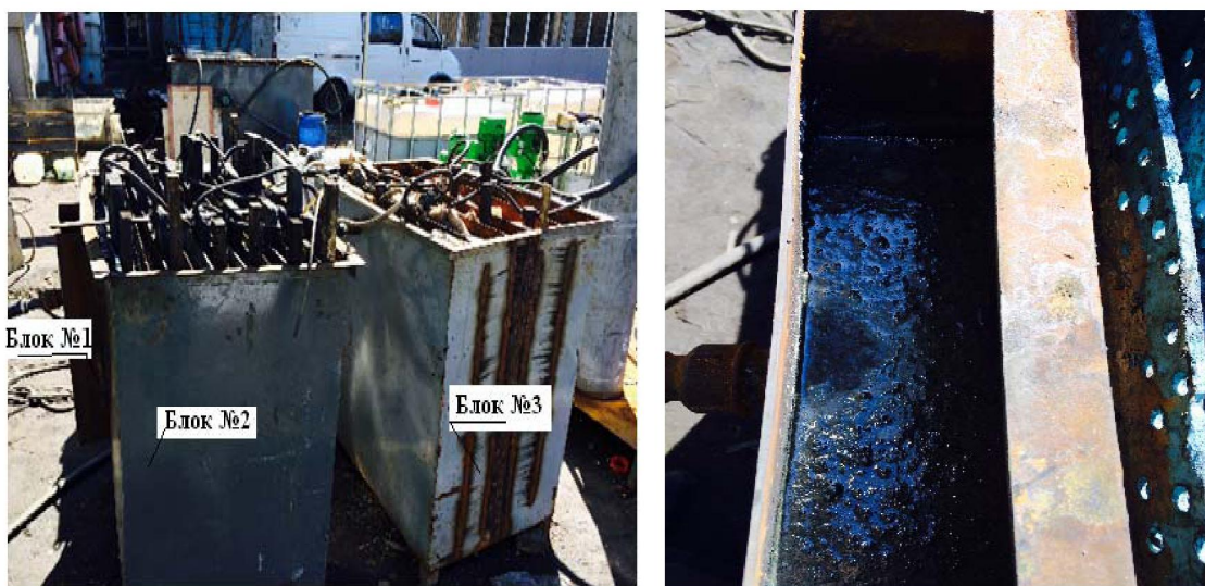
Рисунок 4 - Место ввода технологического конденсата в пилотный электролизер
