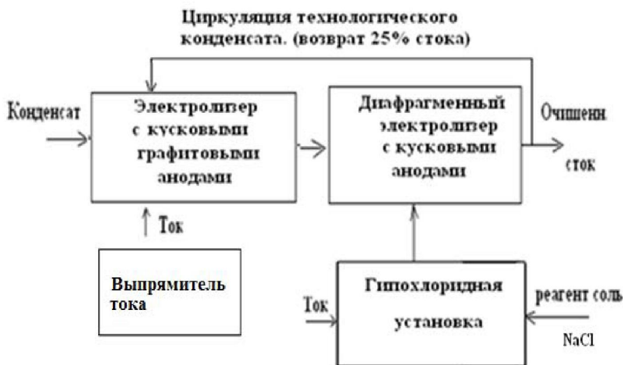
Рисунок 1 – Усовершенствованная принципиальная технологическая схема проведенного пилотного испытания
