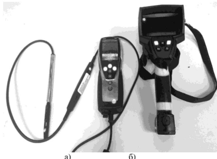
2-сурет – Эксперимент параметрлерін өлшеуіш куралдар: а - анемометр; б - тепловизор.
