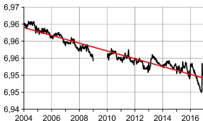
Рисунок 3 - Исходный ряд после применения алгоритма обработки помех осредненным скользящим окном (радиус сглаживания 7 значений) \sigma = 0.001623 , прямая линия – линейный тренд очищенного от помех ряда для вычисления скорости движения GPS станции
