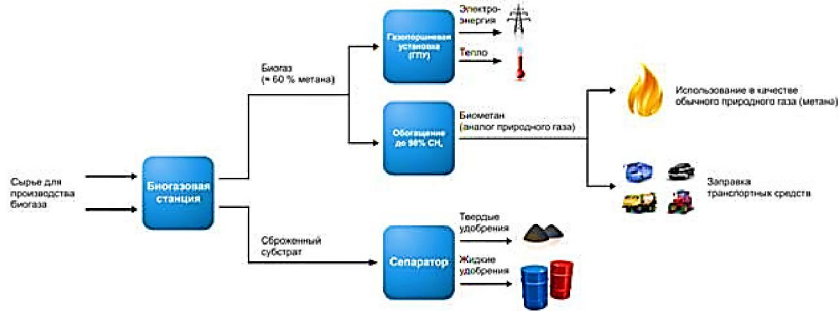
Рисунок 2 – Система получения и сжигания биогаза Figure 2 – System of receiving and combustion of biogas
