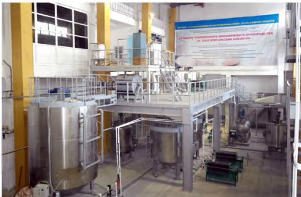
Рисунок 3 – Опытная установка на ОЭМП с общей площадью 540 \text{ м}^2
