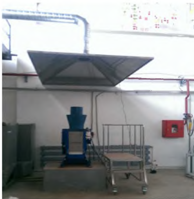
Рисунок 4 – Опытная установка на ОЭМП. Дробилка Laarmann LMFC-250
