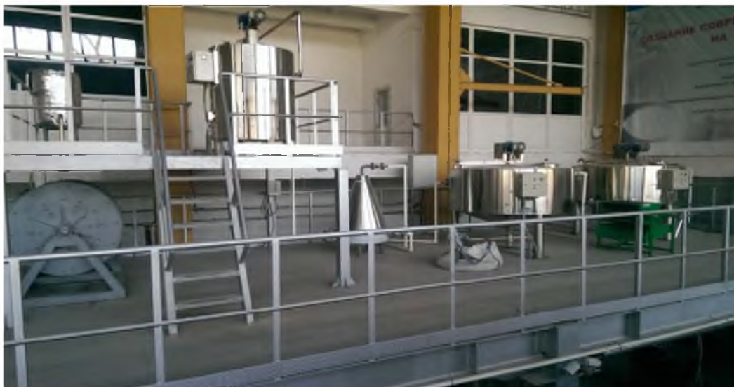
Рисунок 8 – Опытная установка на ОЭМП. Мельница мокрого помола, выщелачиватель, сгустители и фильтр-пресс
