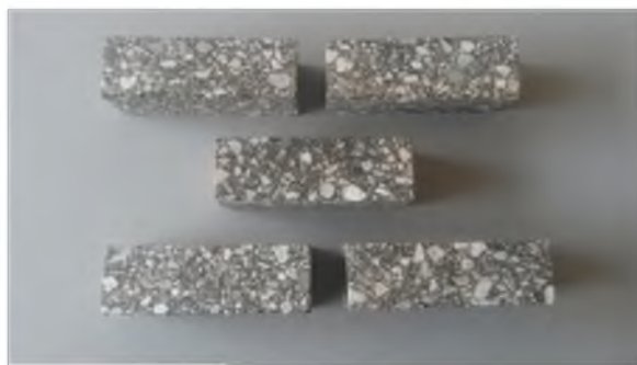
Рисунок 23 – Образцы асфальтобетона размером 5х5х16 см
