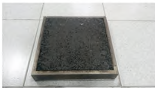
Рисунок 22 – Образец асфальтобетона размером 5х30,5х30,5 см в стальной форме
