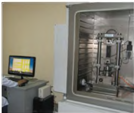
Рисунок 18 – Испытуемый образец асфальтобетона на прямое растяжение в термокамере прибора TRAVIS
