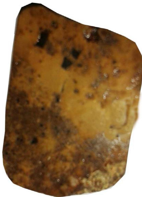
Рисунок 7– Брекчия железненная с включениями рудного минерала. Карамурунская свита. Аншлиф, образец № 22, натуральная величина
