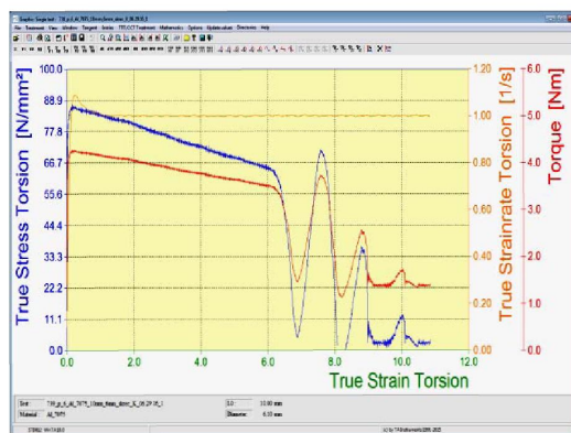
Рисунок 3 – Влияние кручений на изменение сопротивления деформации алюминиевого сплава 7075: а – 200 °С; б – 300 °С; в – 400 °С
