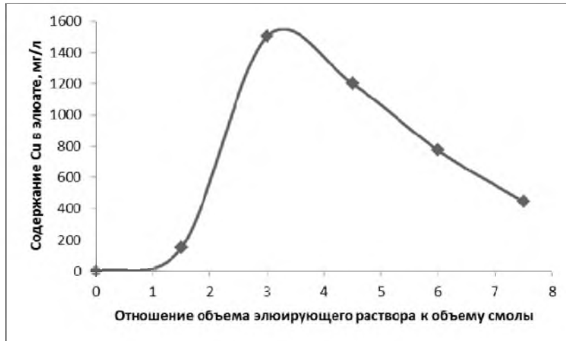
Рисунок 2 – Зависимость содержания меди в элюате от отношения объема элюирующего раствора к объему смолы при концентрации 1,5 % NaCNS + 2,0 % NaOH
