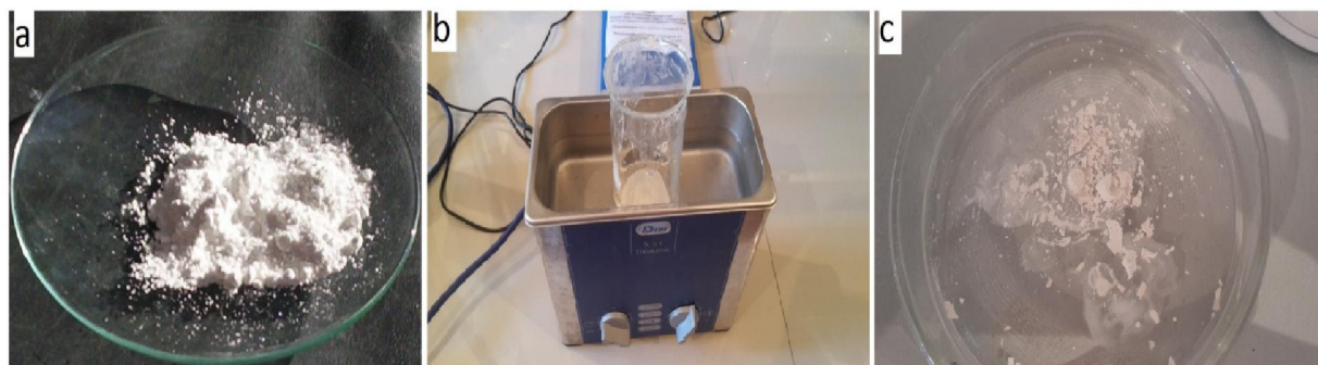
Рисунок 2 - а) – гранулы \text{TiO}_2 ; б) – полученный раствор подвергали воздействию ультразвука (Elmasonic S) в ванне; с) – полученный осадок (наноразмерный \text{TiO}_2 )
