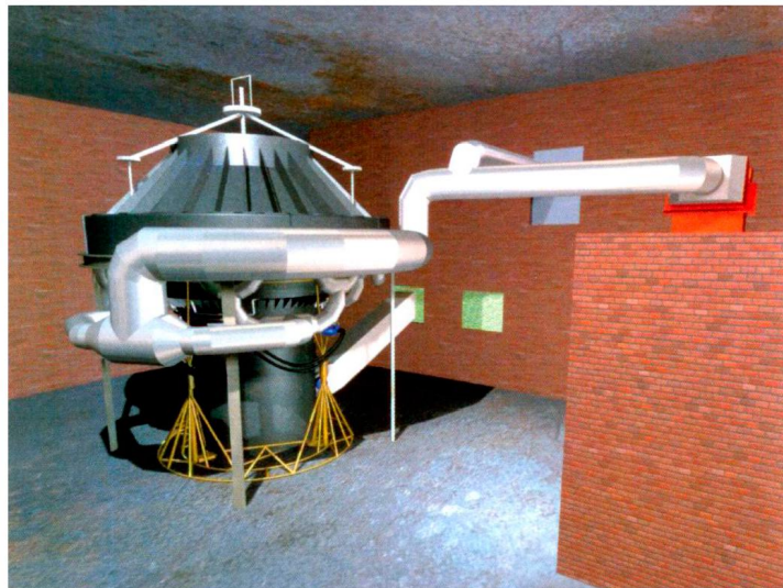
Рис. 4. Промышленная аэрионная газоочистная установка В-9
