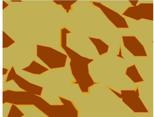
Рис. 1. Электронная микроскопия поверхности Ag, адсорбированного на подложке Si. (а) – эксп. [5], (б) – теор.: \gamma_n = \gamma_p = \gamma_a = I_2 , n_0 = p_0 = a_0 = 5 , n_1 = p_1 = 1 , a_1 = 100
