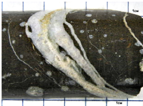
Рис. 7. Трахиандезит-латит после взрывной деформации. Золоторудное поле Уенке-Булак. Горная порода со своими минералами, выполненными кварц-карбонатным веществом с сульфидными включениями (галенит, пирит и др.). Центральная часть прожилков кварца состоит из карбонатов и сопутствующих кварц-карбонатных инъекций, содержащих микрокристаллические сульфиды
