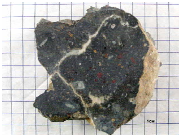
Рис. 3. Лампроит экструзивный. Дайка Сарыккамыс, Бетпак-Дала. Текстура брекчиевидная, взрывного типа. Тонкокристаллическая хлорит-карбонатная основная масса (темный фон) и обломки пород разного состава. Кварц-карбонатный прожилок (белая полоска)
