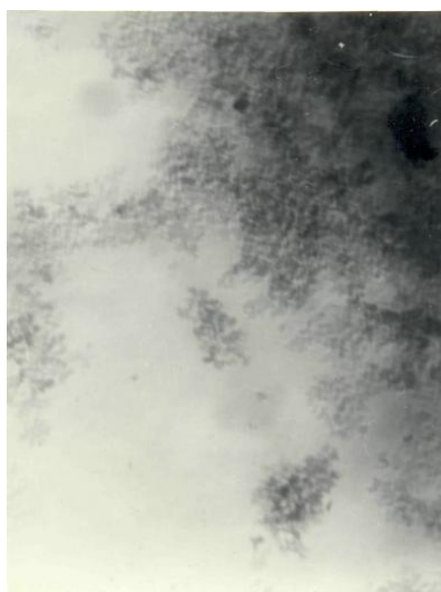
Рис.1. Электронно-микроскопический снимок 5% Cr/SiO 2 катализатора (ув. 120 000)
