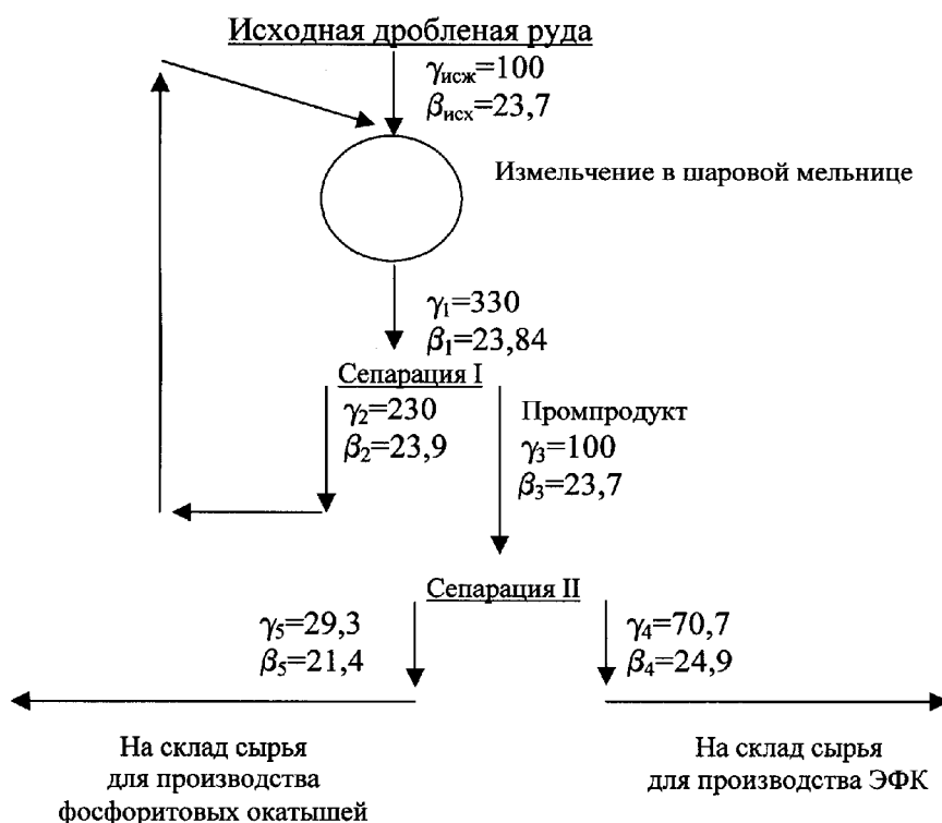
Рис. 2. Качественно-количественная схема измельчения фосфоритов карбонатно-кремнистого типа с применением двухступенчатой воздушной сепарации \gamma – выход продукта, %; \beta – содержание P_2O_5 в продукте, %
