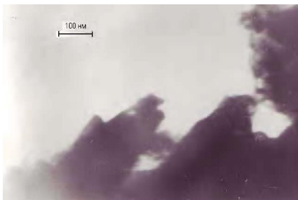
Рис. 4. Электронная микрофотография Cu(II)/ПВПД катализатора, полученного из медного порошка
