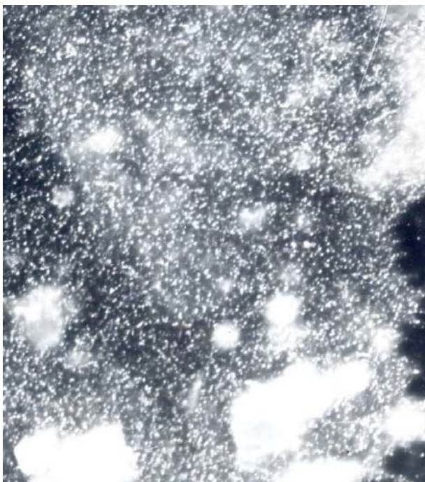
Рис. 1. Электронномикроскопический снимок (темнопольное изображение) коллоидной Pt, стабилизированной ПВПД с MM = 24 \cdot 10^3 ; C_n = 0,2\% ; t_{\text{восст.}} = 30 мин. Увеличение 160000. 1мм-6 нм
