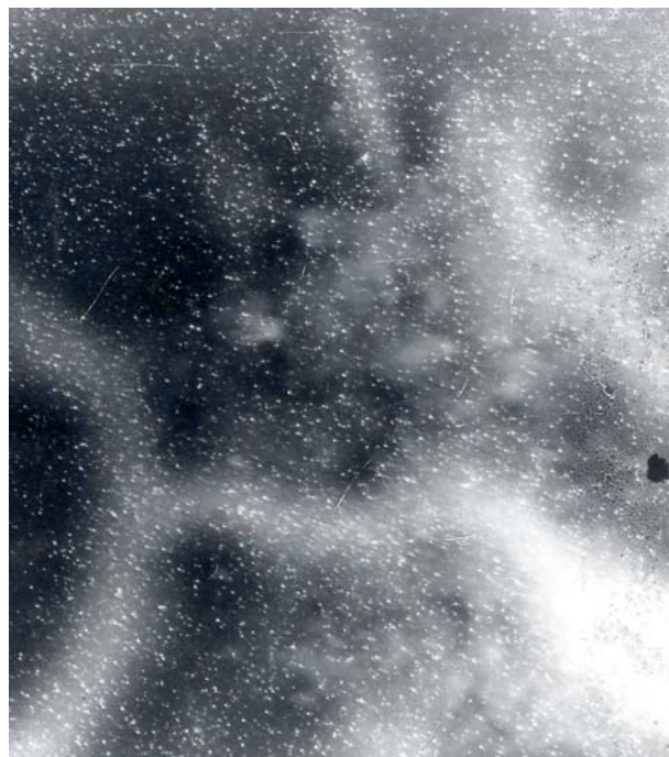
Рис. 3. Электронномикроскопический снимок (темнопольное изображение) коллоидной Pt, стабилизированной ПВПД с MM = 560 \cdot 10^3 ; C_n = 0,2\% ; t_{\text{восст.}} = 2 часа. Увеличение 160000. 1мм-6 нм
