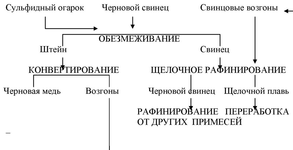
Рис. 1. Принципиальная технологическая схема совместной переработки конвертерной пыли и чернового свинца
