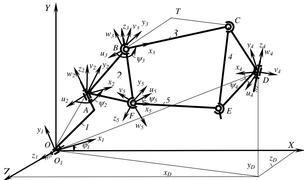
плоскости;  $X_{D1}$ ,  $Y_{D1}$ ,  $Z_{D1}$ ,  $X_{Ci}$ ,  $Y_{Ci}$ ,  $Z_{Ci}$  – соответствующие координаты точек  $D_1$  (центра сферы) и  $C$  в абсолютной системе координат  $OXYZ$  [2]. По условию синтеза координаты точки  $C$  звена 3, которому принадлежат локальные координаты выходной точки  $T$ , в абсолютной системе координат  $OXYZ$  определяются с использованием обобщенного метода символьических обозначений преобразования координат в виде:
