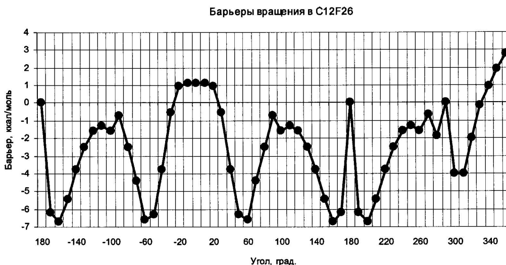
Рис. 3. Барьеры внутреннего вращения в C_{12}F_{26} вокруг центральной связи C_6-C_7 с полной оптимизацией всех остальных геометрических параметров, рассчитанные методом PM3
