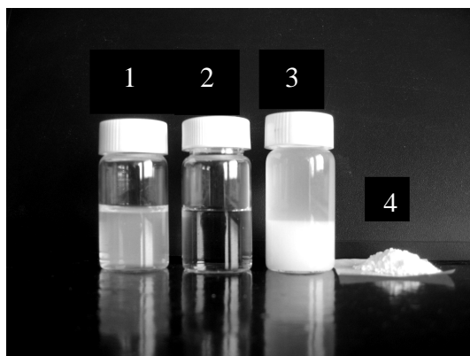
Рис. 6. Фотографии коллоидных частиц кремнезема AS-40 (1), водного раствора JR-400 (2), интерполиэлектролитного комплекса (ИПЭК), выпавшего в осадок из водного раствора (3), и нанопорошка ИПЭК (4)
