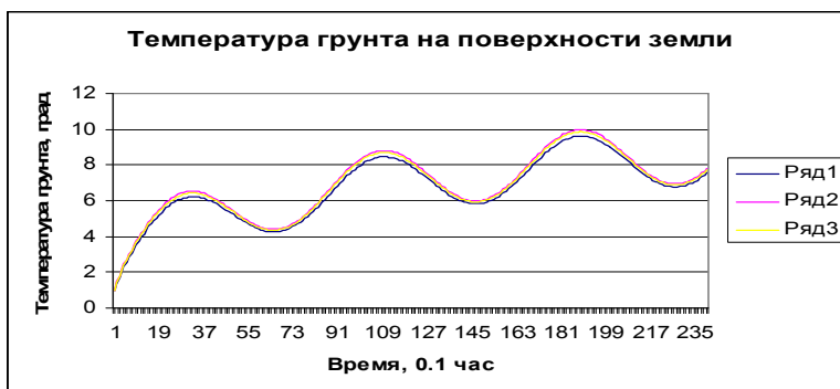
Рис. 1. Приближенная температура грунта на поверхности земли. Температура грунта на поверхности земли: первый ряд – точное значение, второй – через 100 итерации, третий ряд – через 200 итерации
