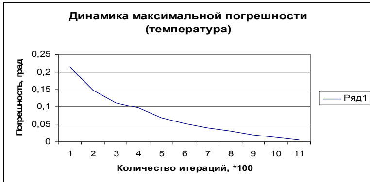
Рис. 2. Зависимость максимальной погрешности отклонения температуры грунта на поверхности земли от количества итерации
