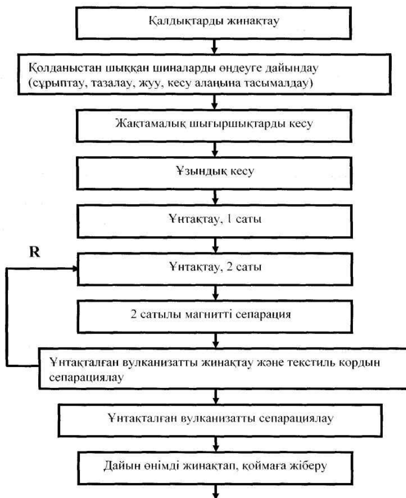
1-сурет. Қолданыстан шыққан шиналарды механикалық қайта өңдеудің технологиялық сұлбасы: R - өлшемі 3 мм-ден жоғары ұнтақталған вулканизатты ұнтақтау сатысына қайтару
