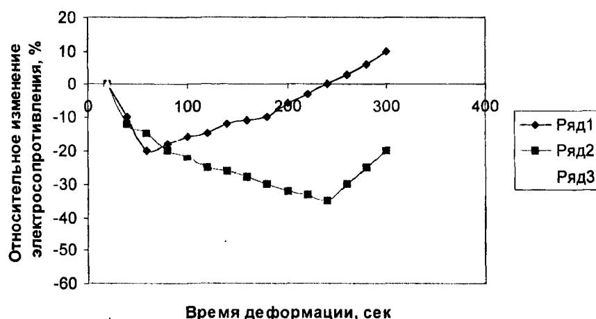
**Рис. 4.** Относительное изменение электрического сопротивления в процессе деформации образца из бескислородной меди:
