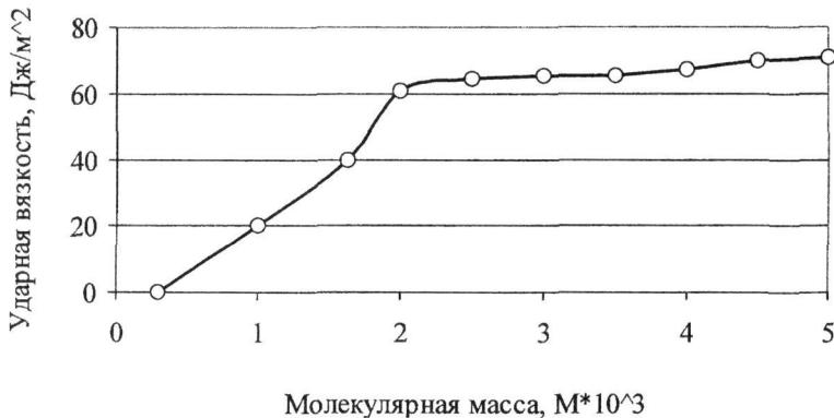
Рис. 3. Зависимость ударной вязкости полистирола от молекулярной массы
