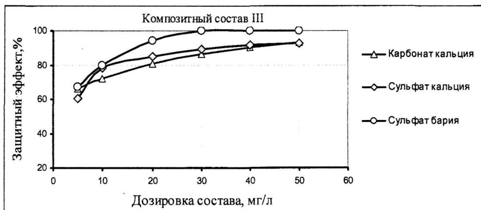
Рис. 1. Эффективность ингибирующего состава оксиэтилендифосфоновой кислоты и аммиака по отношению к отложению неорганических солей при различных дозировках.
