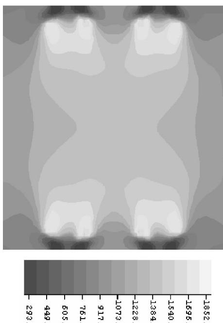
Рис. 8. Поле температур в поперечном сечении топки на уровне расположения горелок при традиционном режиме горения
