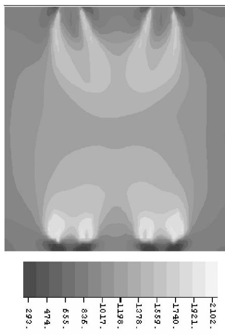
Рис. 9. Поле температур в поперечном (слева) и продольном (справа) сечениях топки в плоскости расположения горелок и ПТС при сжигании угля с использованием двух ПТС
