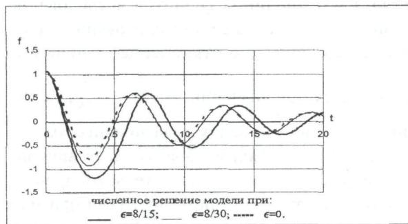
Рис.4. Влияние степени нелинейности модели и ее линеаризация на ее численное решение.
