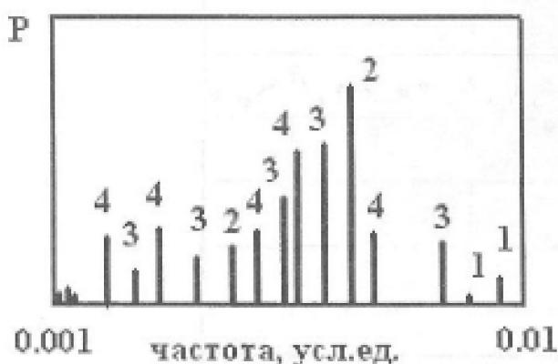
Рис.3. Частотные спектры волнового поля среды в различных состояниях. 1- без разрывов, 2 – после возникновения разрыва, 3 – длина разрыва увеличена на 25%, 4- 40%.
