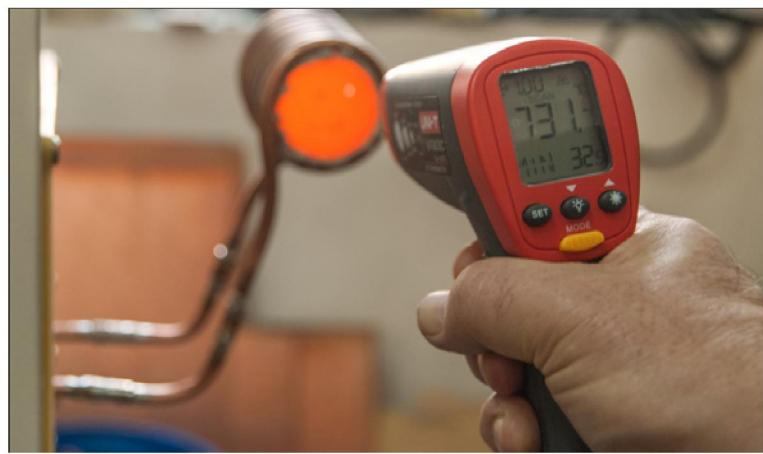
Рисунок 3 – Процесс индукционного нагрева металла до температуры 731°C
