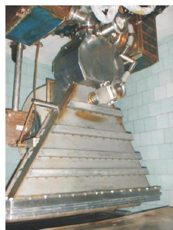
**Рис. П-4.** Промышленный электронный ускоритель ЭЛВ-4
