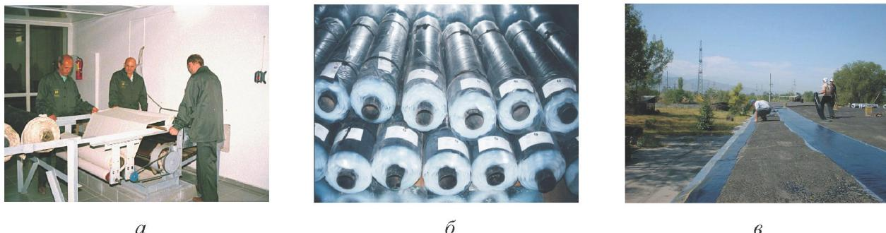
Рис. 8. Кровлен: *а* – производство «Кровлена-2»; *б* – готовая продукция; *в* – ремонт мягкой кровли
