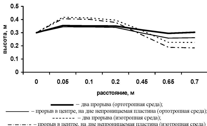
Рис.3. Сравнение расчетных результатов для потенциала скорости при течении через дамбу для изотропной и ортотропной среды при коэффициентах  $k_1=0.9$ ,  $k_2=0.2$
