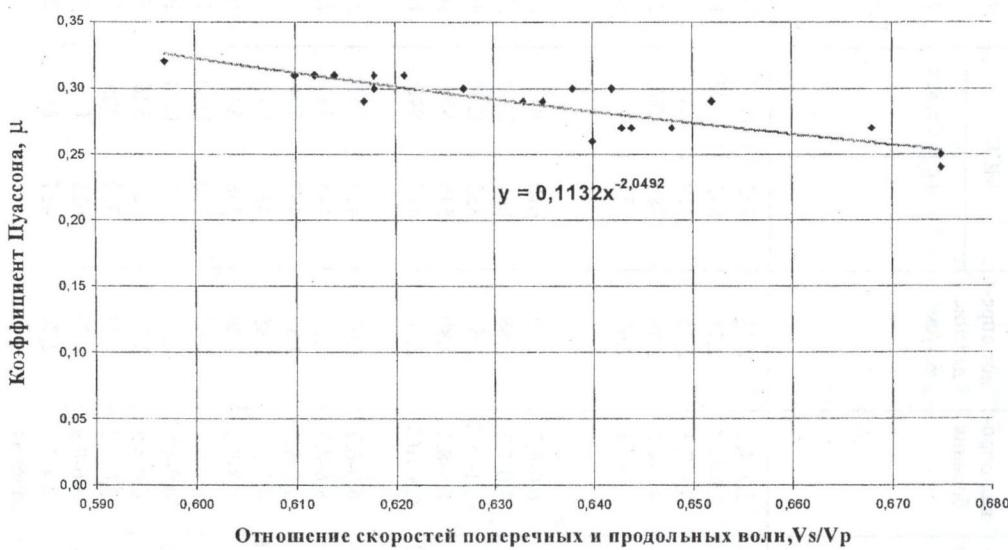
Рис.2. Корреляционная связь между коэффициентом Пуассона и скоростями сейсмических волн
