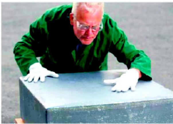
**Рис. 4.1.** Заготовки поликристаллического кремния, полученные методом направленной кристаллизации 680x840 мм<sup>2</sup>. Из них путём резки получают 16-25 блоков 156x156 мм<sup>2</sup> [8, 16]
