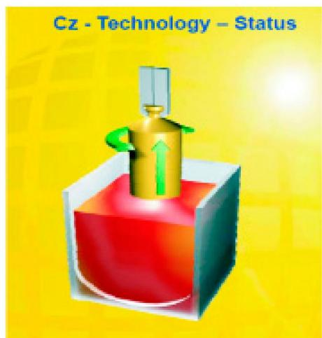
**Рис. 4.2.** Макет установки по выращиванию монокристаллов кремния методом Чохральского. Диаметр слитков около 200 мм<sup>2</sup> [16]
