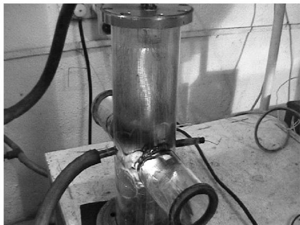
Рис. 1. Фотография горелочного устройства с тлеющим разрядом
