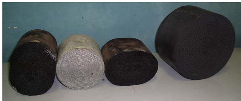
Рис. 1. Металлические блочные катализаторы
