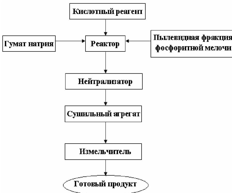
Рис. 1. Принципиальная технологическая схема процесса получения гуматсодержащих комплексных удобрений
