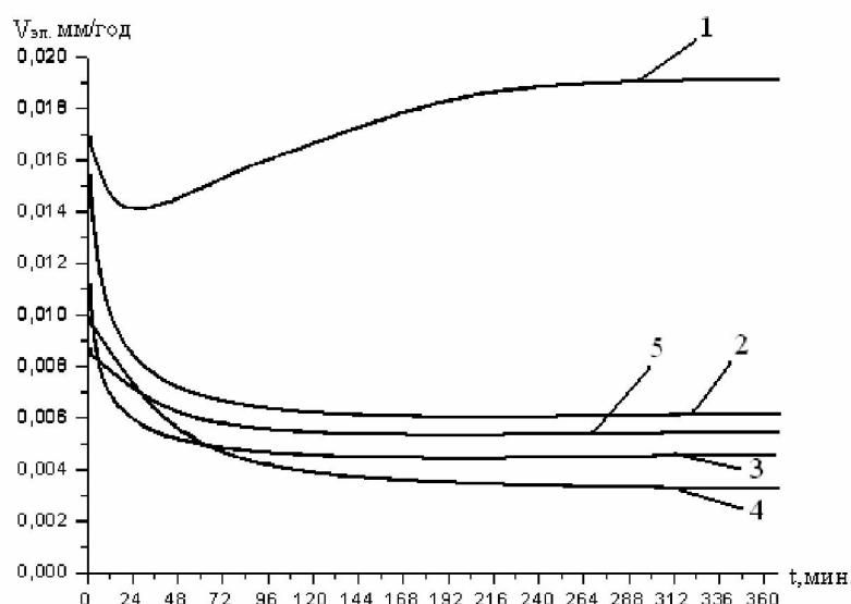
Рисунок 2 – Изменение скорости коррозии стали (Ст.3) от времени выдерживания в водном растворе, содержащем постоянную концентрацию ZnHTФ и разные концентрации лигносульфоната натрия (мг/л): 1-0; 2-5; 3-10; 4-204 5-40
