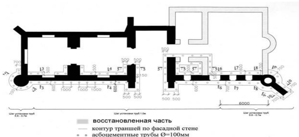
Рисунок 3 – Схема расположения траншей и вентиляционных труб
