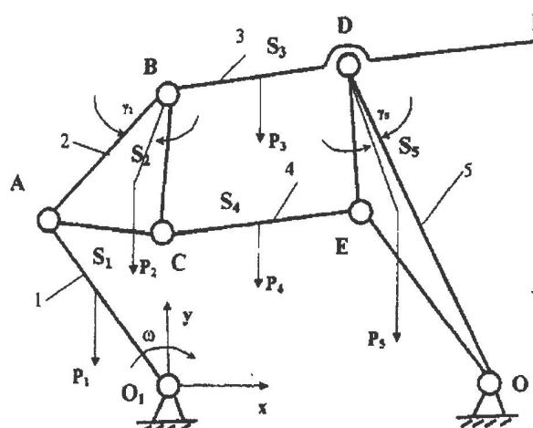
Рис. 2 Кинематическая схема подъемника
