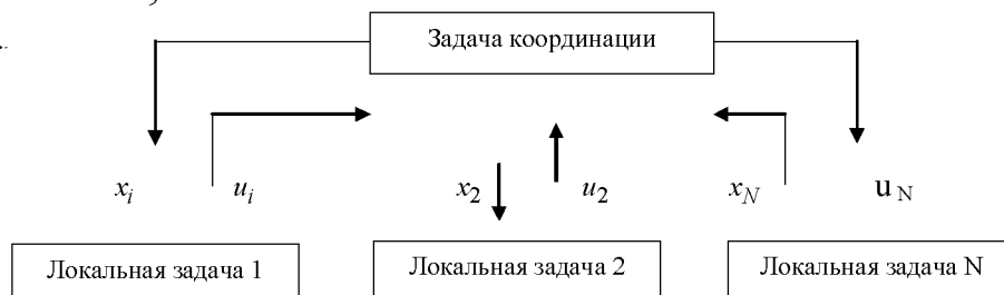
Рис. 1. Двухуровневая схема решения задачи управления. x_i – параметры координации, u_i – решения локальных задач
