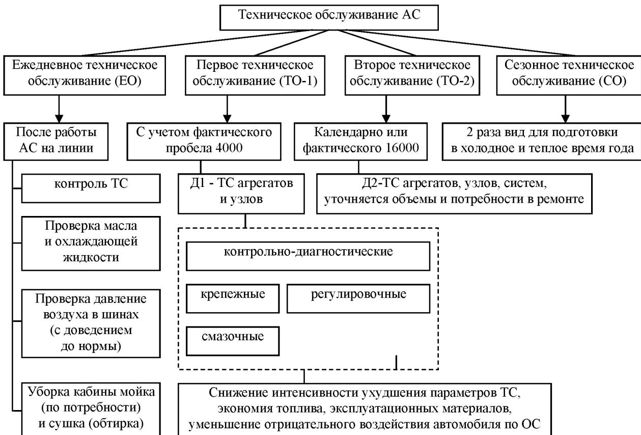
Рисунок 3 – Техническое обслуживание автомобильного транспорта
