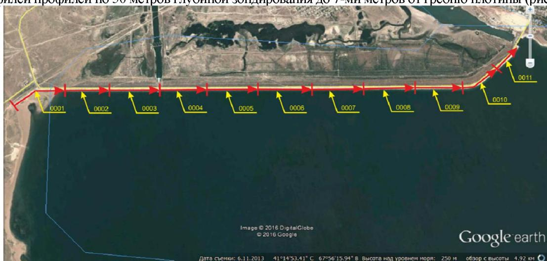
Рисунок 1 – Расположение георадарных профилей на Шардаринском гидрокомплексе.
